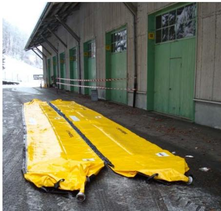
Die Dämmelemente werden gestreckt ausgelegt
